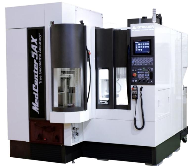
自動パレット交換装置システム例
