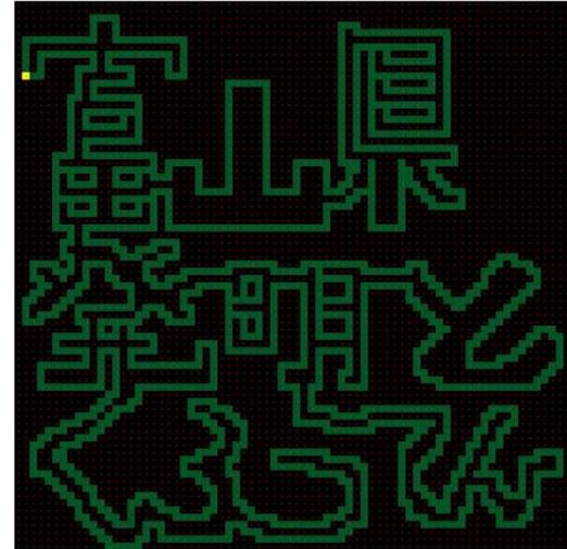
左の「富山県発明とくふうてん」の形状をした交差点は2495bitで表現できます。黄色のマスがスタート地点で、濃い緑色のマスが1つの閉ループになっています。左の盤面は75x75マスで、1マスは25cmを表しています。そのため左の交差点のサイズは18.75mです。
